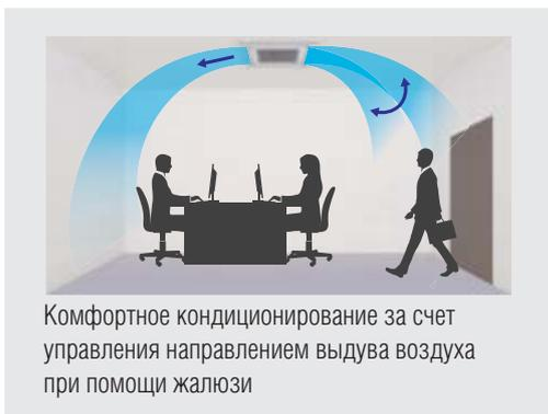
Комфортное кондиционирование за счет управления направлением выдува воздуха при помощи жалюзи
