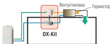
При подсоединении к теплообменнику системы вентиляции VRF-системы Fujitsu датчик контролирует температуру подаваемого воздуха.
