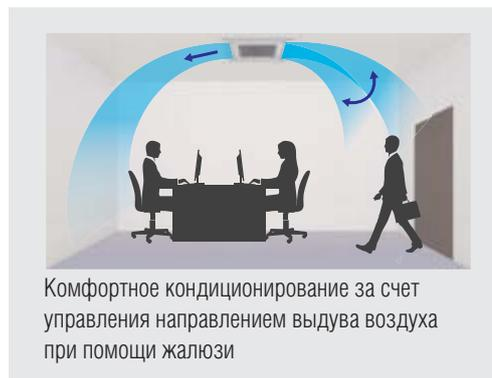
Комфортное кондиционирование за счет управления направлением выдува воздуха при помощи жалюзи
